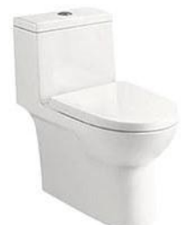
BX-1642 虹吸式連體坐便器 尺寸: 690x385x710 毫米 地排污: 排污口中心離地 300、400 毫米 配: PP/UF 柔壓板 Siphonic One-piece water closet Size: 690x385x710mm S-trap: 300、400mm Roughing-in Including: PP/UF thermosetting soft-close seat cover
