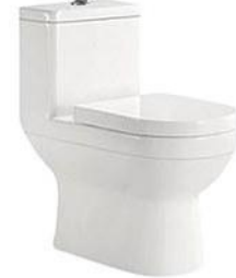
BX-1634 虹吸式連體坐便器 尺寸: 680x360x700 毫米 地排污: 排污口中心離地 300、400 毫米 配: PP/UF 柔壓板 Siphonic One-piece water closet Size: 680x360x700mm S-trap: 300、400mm Roughing-in Including: PP/UF thermosetting soft-close seat cover
