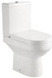
IM-80136 直衝式分體坐便器 尺寸: 635x370x850 毫米 橫排污: 排污口中心離地 185 毫米 配: UF 柔壓板 Washdown Two-piece water Closet Size: 635x370x850mm P-trap: 185mm Roughing-in Including: UF thermosetting soft-close seat cover
