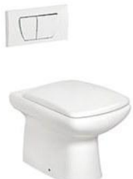
IM-1064B 坐地廁 尺寸: 580x380x400毫米 橫排污: 排污口中心離地 185 毫米 配: UF柔壓板 Back to wall W.C Size: 580x380x400mm P-trap: 185mm roughing-in Including: UF thermosetting soft-close seat cover
